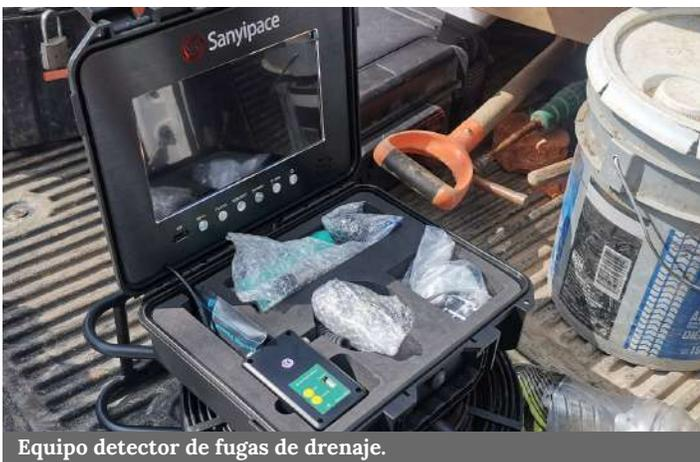
Equipo detector de fugas de drenaje.
