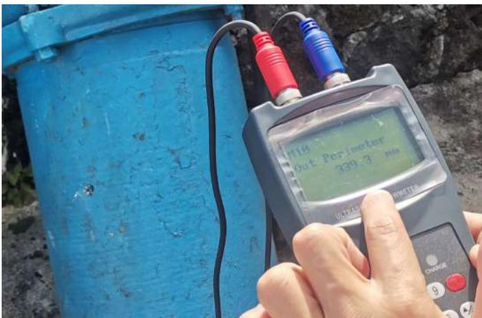
Medidor ultrasónico portátil para medición de caudales en captaciones.
